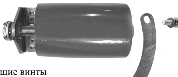
3. Прикрепите корпус доводчика, используя самонарезающие винты с плоской головкой (4 шт.) через пластинки, к полотну двери перпендикулярно оси ее вращения, предварительно нагрузив внутреннюю пружину. Для натяжения пружины следует сдвинуть корпус доводчика в сторону от оси кронштейна так, чтобы шток рычага вышел дополнительно из корпуса наружу приблизительно на 5 мм. Установите крышки на торцах корпуса доводчика с обеих сторон для скрытия элементов крепежа.
